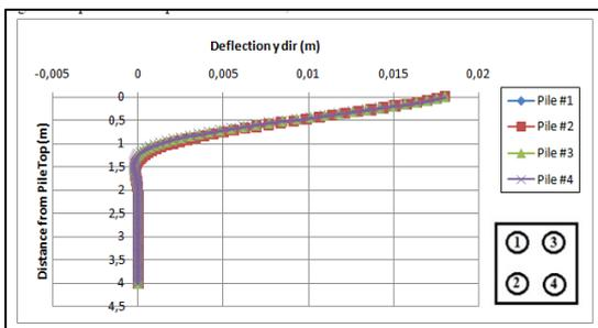
**Gambar 15.** Grafik hubungan perpindahan lateral terhadap kedalaman tiang grup 2 x 2 jarak 3D. Dari Gambar 15 diatas, terlihat perpindahan tiang tunggal berdasarkan komputasi menggunakan GROUP (metode p-y) mendapatkan defleksi tiang sebesar 18 mm.
