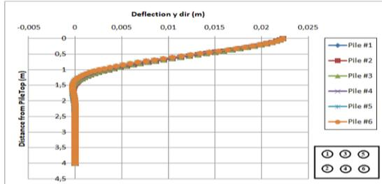
**Gambar 20.** Grafik hubungan perpindahan lateral terhadap kedalaman tiang grup 2 x 3 jarak 3,5D
